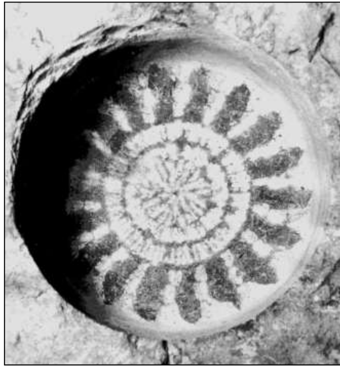
Рисунок 1. 28 – Поверхня вибою свердловини під час буріння долотом 93Т в пісковнику воротищенської світи твердістю p_{ui}=1440 МПа, число зубців периферійної рейки – 18
