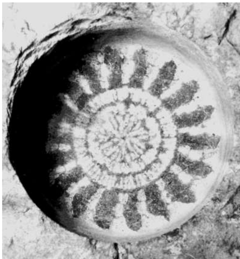
Рис. Е.1 – Поверхня вибою свердловини під час буріння долотом 93Т в пісковнику воротищенської світи твердістю p_{III}=1440 МПа, число зубців периферійної рейки – 18.
