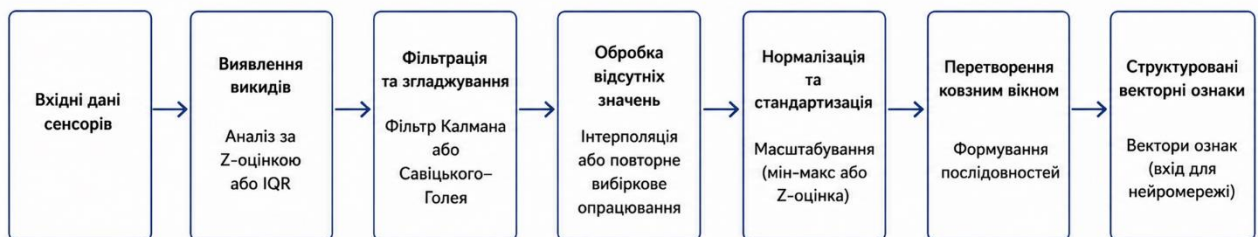
Рисунок 2.4. Структурна схема препроцесингу даних параметрів телеметрії
