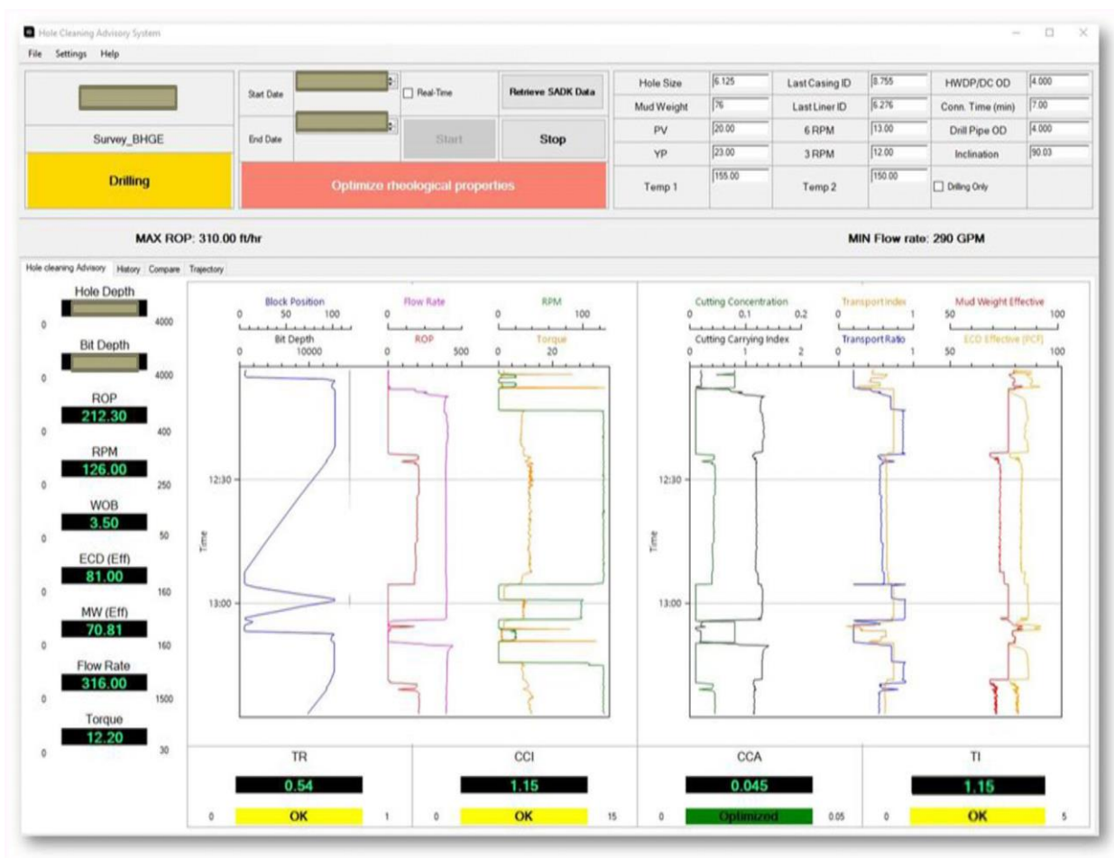
Рисунок 1.4. Система консультацій щодо очищення свердловини в режимі реального часу [19]
