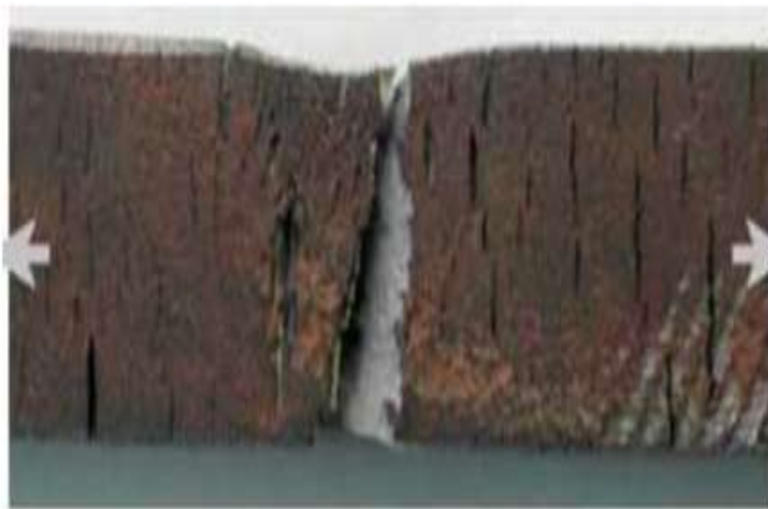
Рисунок 3.7 – Взірець охрупчення сталі після випробування на розтяг
