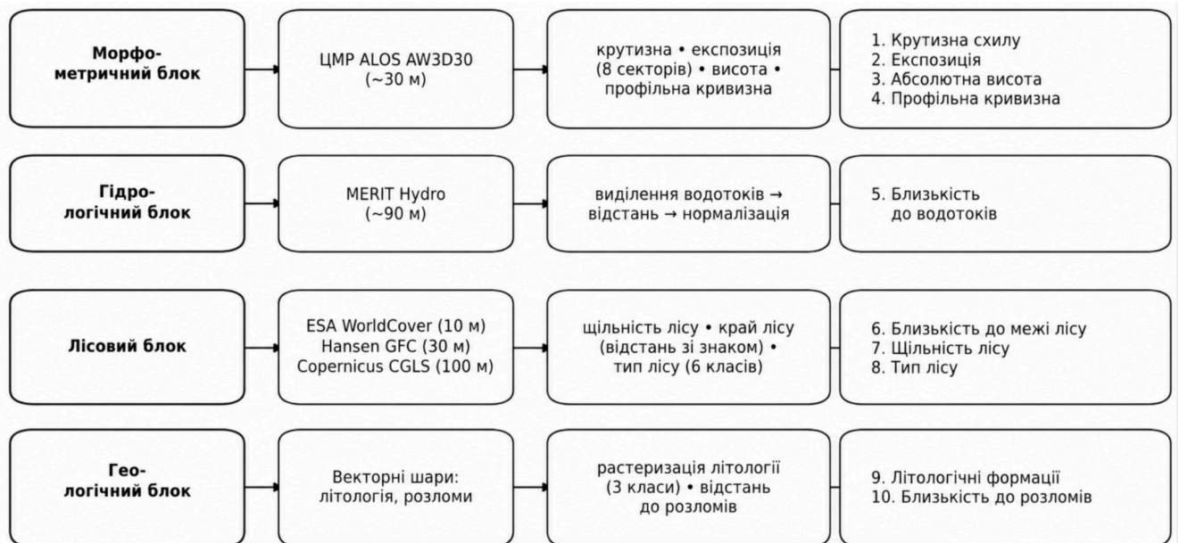
Рисунок 4.3 - Загальна схема формування факторних шарів моделі LSA з чотирьох тематичних блоків: джерела даних, алгоритми обчислення, просторова розрізненість
