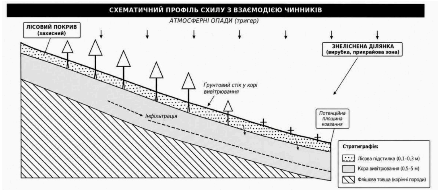
Рисунок 3.2 - Схематичний профіль схилу з відображенням взаємодії чинників на залісений та знеліснений ділянках
