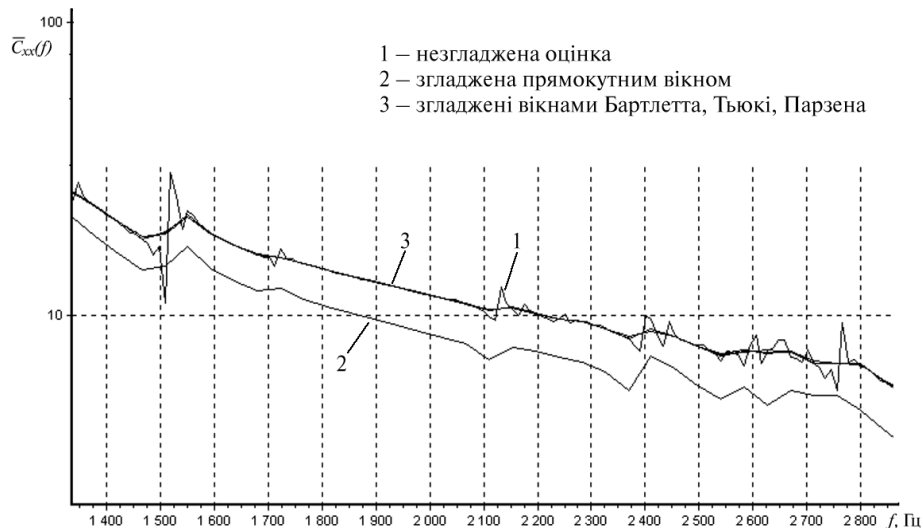
Рис. 3. Спектральні характеристики шуму вимірюваного середовища для витрати 3,9 \text{ м}^3/\text{год} , згладжені різними спектральними вікнами
