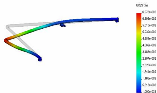
Рис.4. Деформації ділянки газопроводу від зміни температури труби
