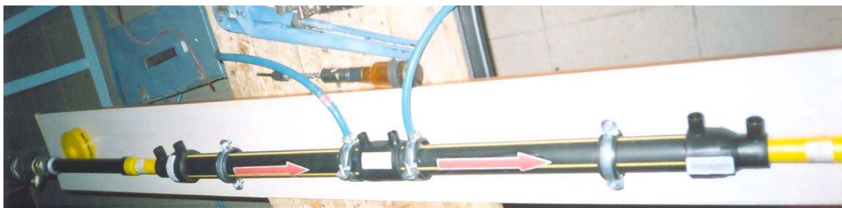
Рисунок 2 – Частина експериментальної установки для досліджень місцевих втрат
