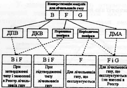
Рис. 8. Структурна схема оцінки відповідності лічильників газу до вимог ТР
