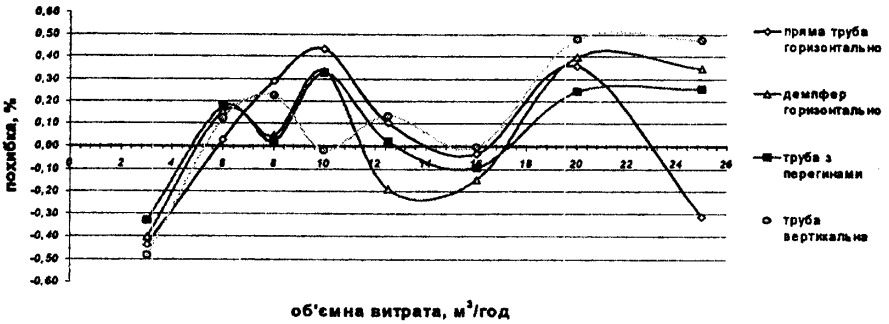
Рис. 6. Криві похибки еталонного лічильника від конструкції приєднувальних трубопроводів повітряних установок і значень відтворюваних витрат газу
