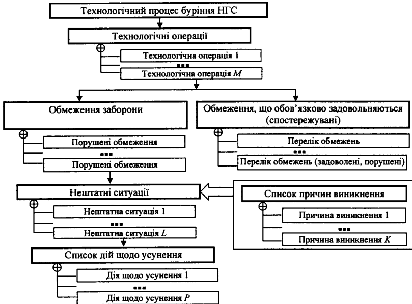
Рис. 3. Алгоритмічна схема визначення нештатних технологічних ситуацій на основі обмежень у процесі буріння НГС
