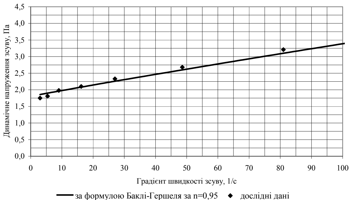
Рисунок 1 — Залежнiсть динамiчного напруження зсуву вiд градiєнта швидкостi зсуву для долинської нафти, що перекачувалась у березнi 2008 р. (температура пiдiгрiву 70°C, робоча температура нафти 30°C)
