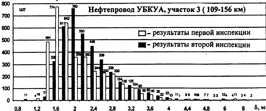
Рис.4. Распределение дефектов по глубинам на участке нефтепровода по результатам инспекций
