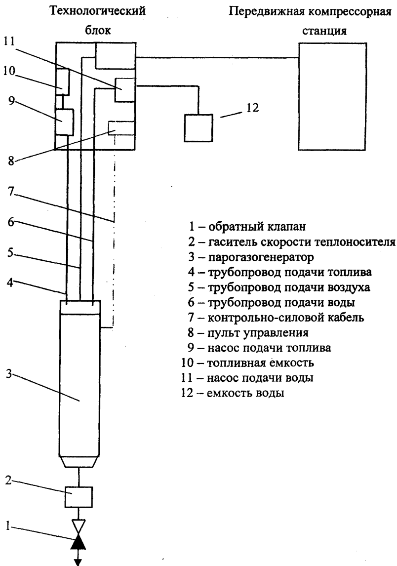
Рисунок 7 – Схема парогазогенераторной установки
