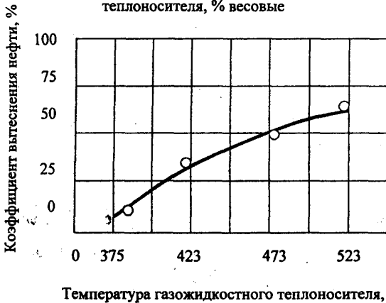
Рисунок 5 - Зависимость коэффициента вытеснения нефти от температуры газожидкостного теплоносителя
