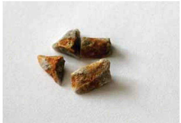
Фото 4 Зразок вапняку у кінці експерименту
