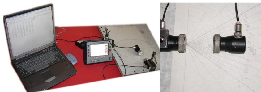
Рисунок 4.34 - Вимірювання діаграми направленості розробленого перетворювача
