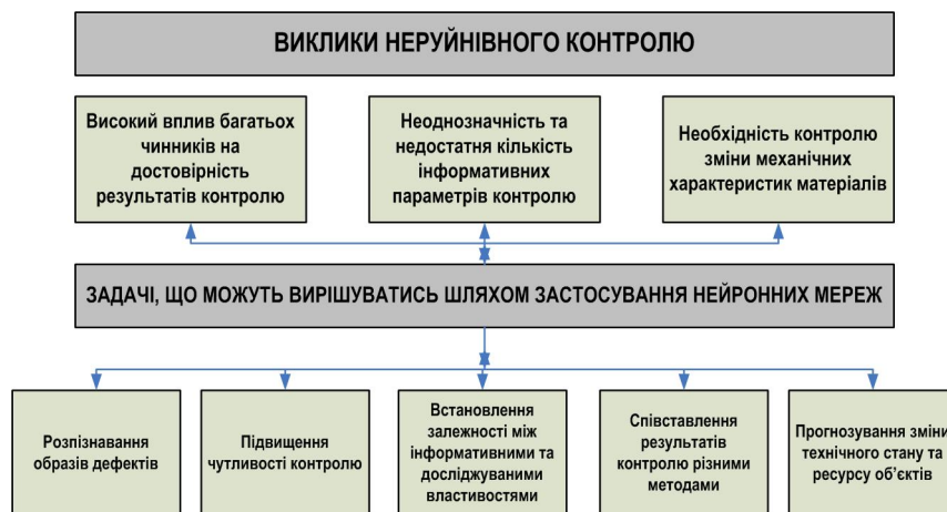
Рисунок 4.48 – Проблеми неруйнівного контролю та напрямки їх вирішення з допомогою штучних нейронних мереж
