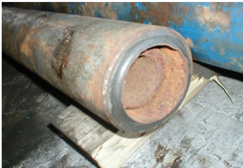
Рисунок 1. 4 – Корозійне пошкодження внутрішньої поверхні бурильної труби
