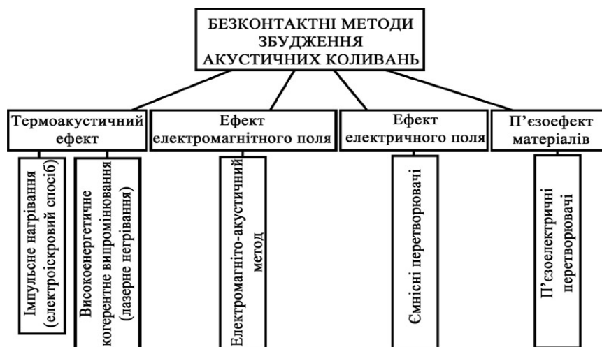
Рисунок 4.12 - Безконтактні методи збудження акустичних коливань
