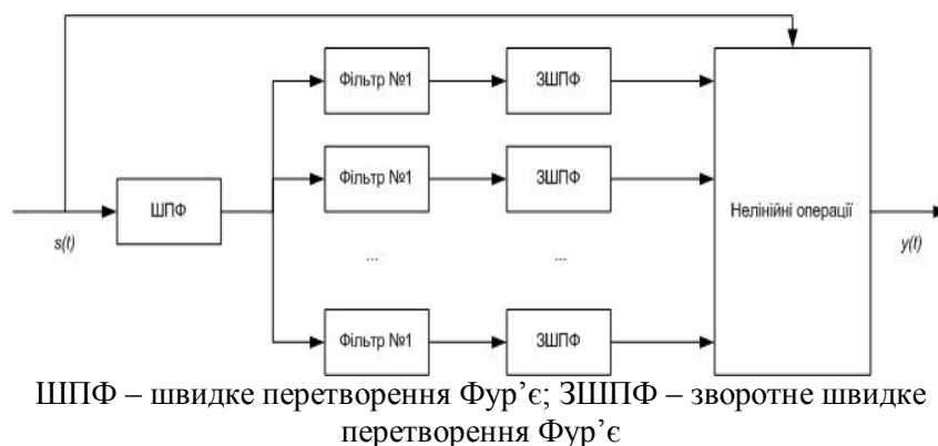
Рисунок 4.47 – Обробка сигналу за допомогою методу роздільних спектрів
