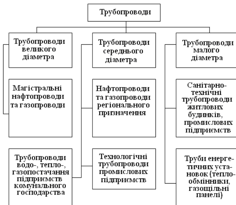
Рисунок 1.8 – Класифікація трубопроводів різного призначення
