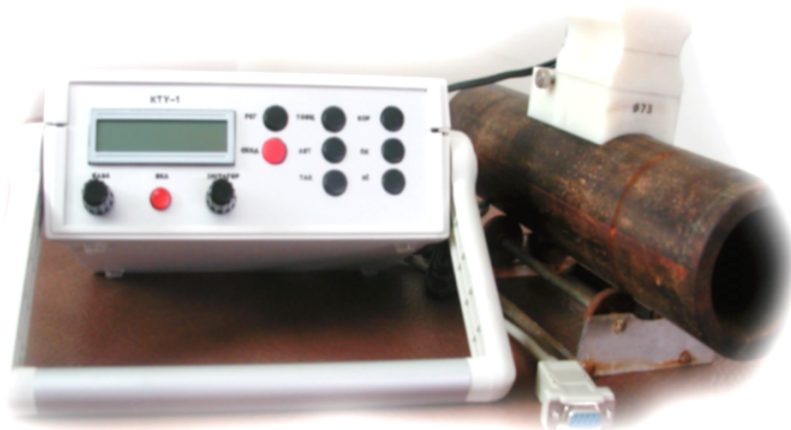
Рисунок 5.2 - Ультразвуковий корозиметр-товщиномір КТУ-1
