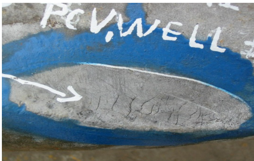
Рисунок 1.5 – Металургійні дефекти калібратора
