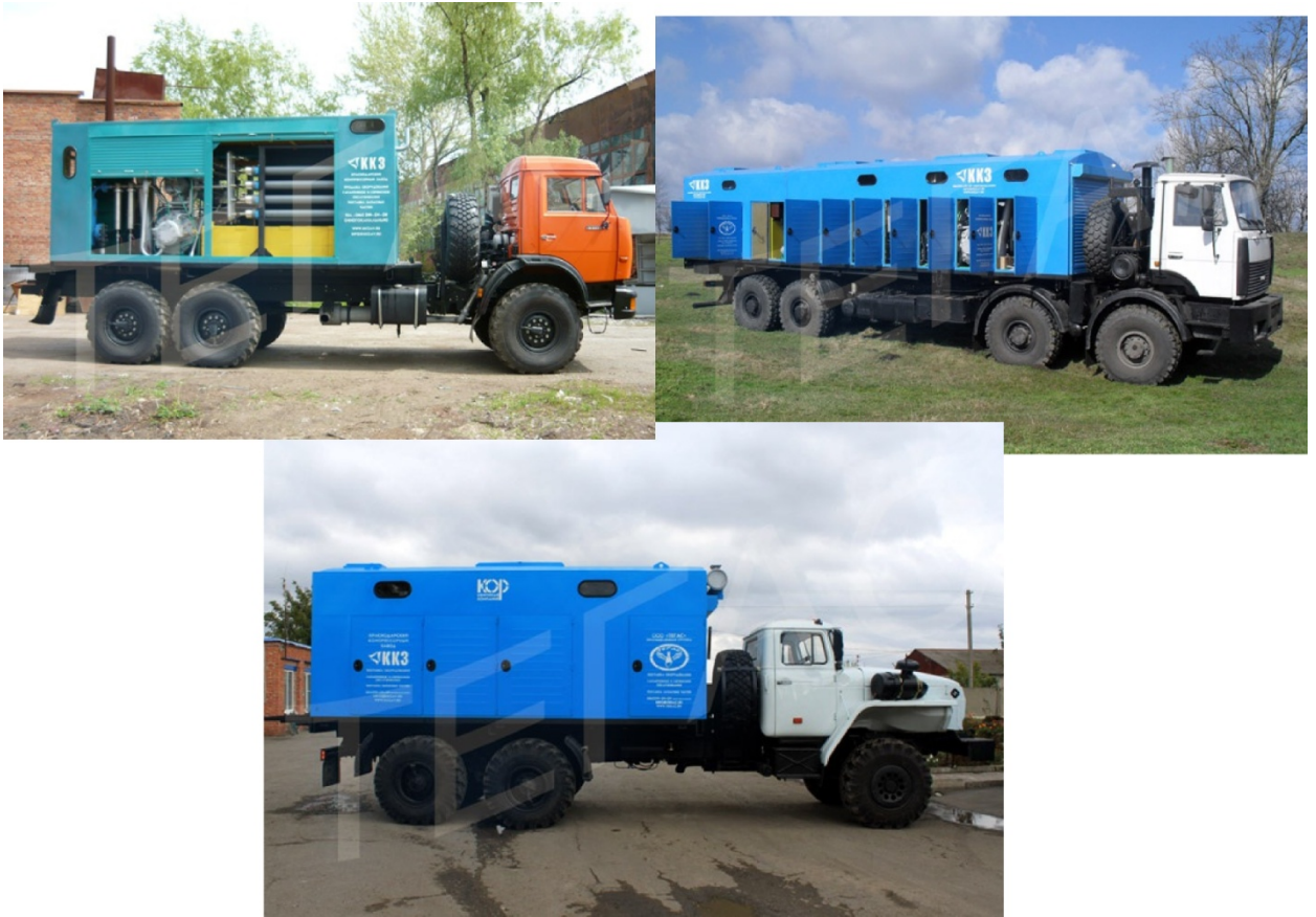
Рисунок 7 – Азотні газогенераторні установки на базі автомобільних шасі
