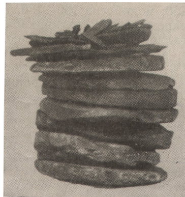
Рисунок 5 – Керн баженіту (верхня юра), Салимська площа (Західний Сибір), св. 52-Р, інтервал 2907-2913 м
