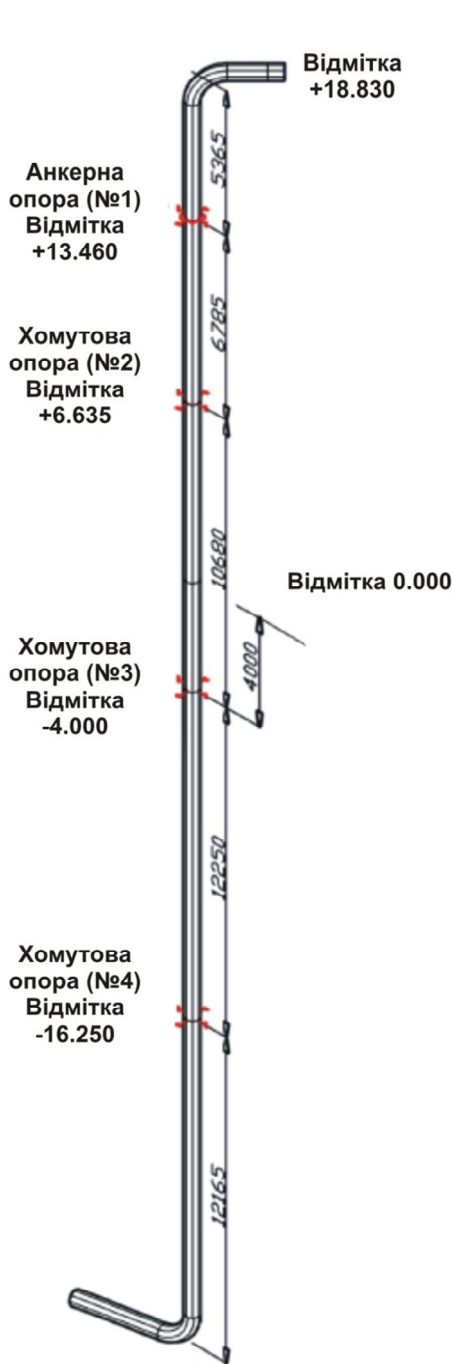
Рисунок 3 – Просторова розрахункова модель стояка
