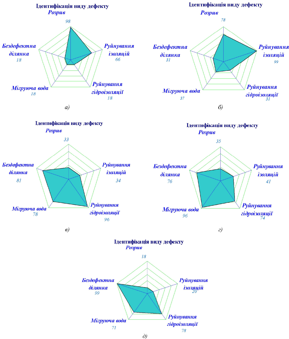
Дефекти: а – “розрив трубопроводу”; б – “руйнування теплової та гідроізоляцій”; в – “руйнування гідроізоляції”; г – “мігруюча вода”; д – бездефектна ділянка контролю
