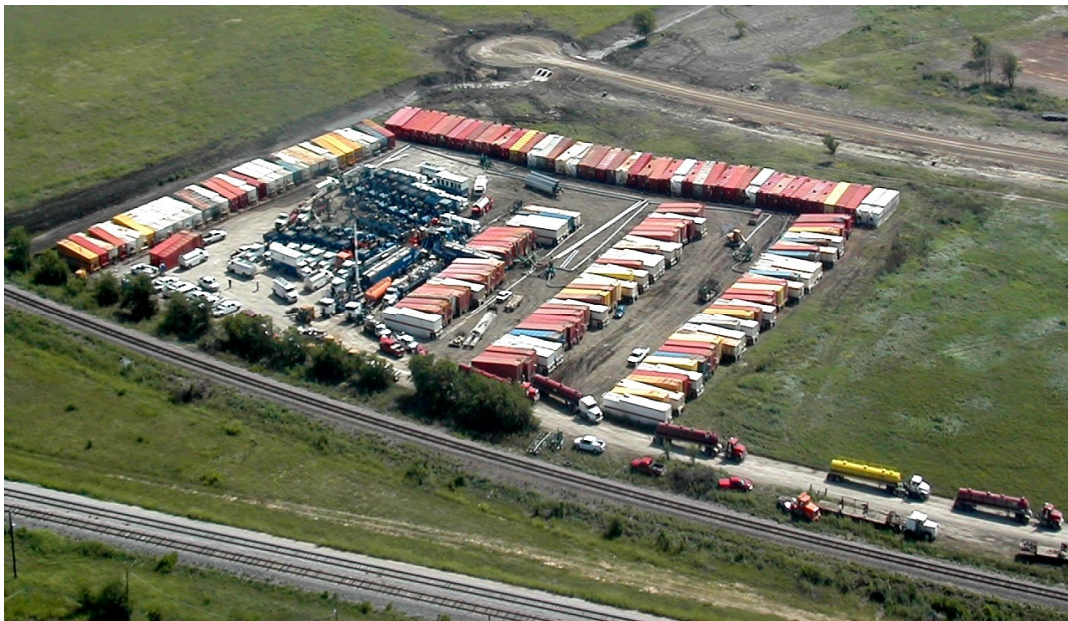
Рисунок 6 – Вантажівки з хімічними реагентами та водою для проведення гідравлічного розриву пласта (за матеріалами Schlumberger)
