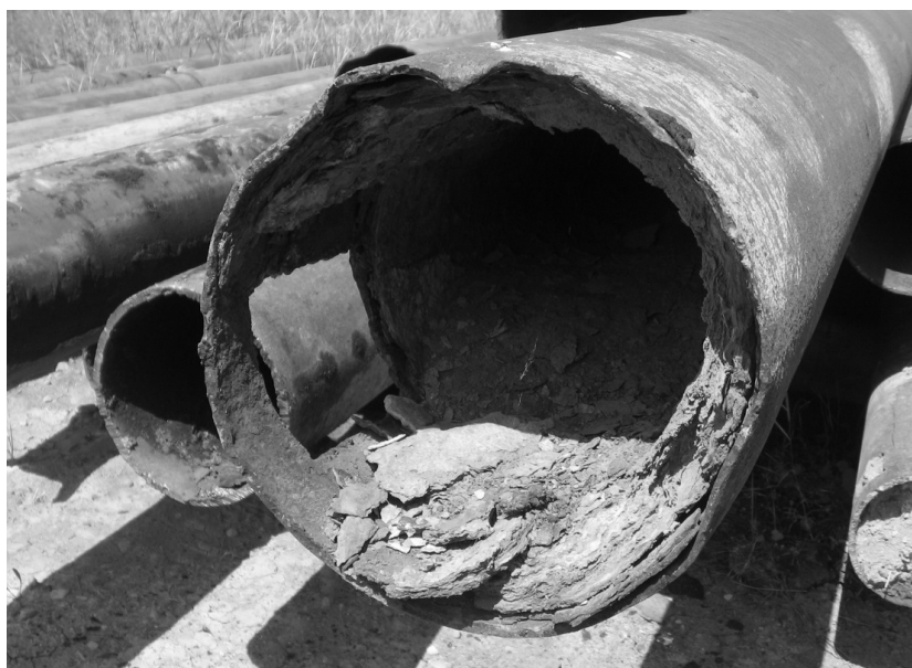
Рисунок 2 – Труба з мінеральними відкладеннями, що містять NORM
