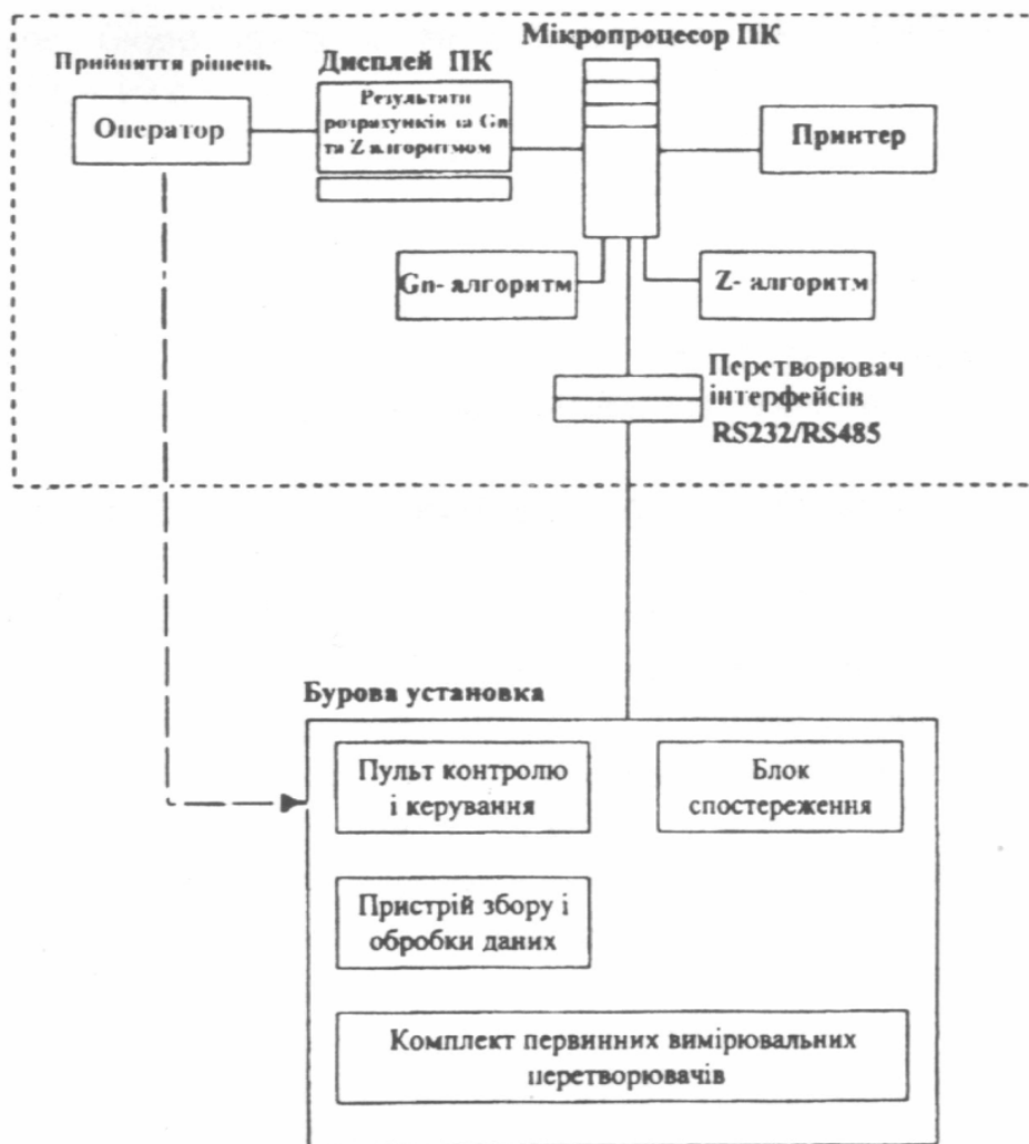
Рисунок 2 – Функціональна схема пристрою визначення зміни меж пластів
