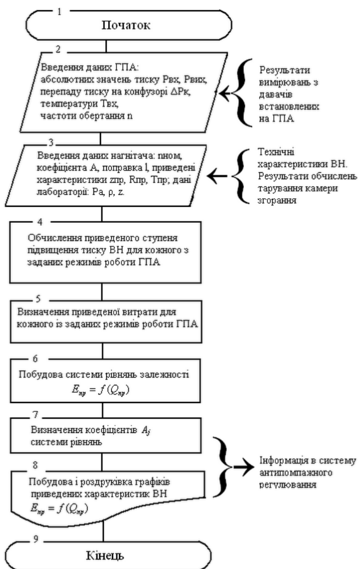
Рисунок 6 – Блок-схема алгоритму програми побудови графіків приведених витрато-напірних характеристик ВН ГПА ДКС ПГС
