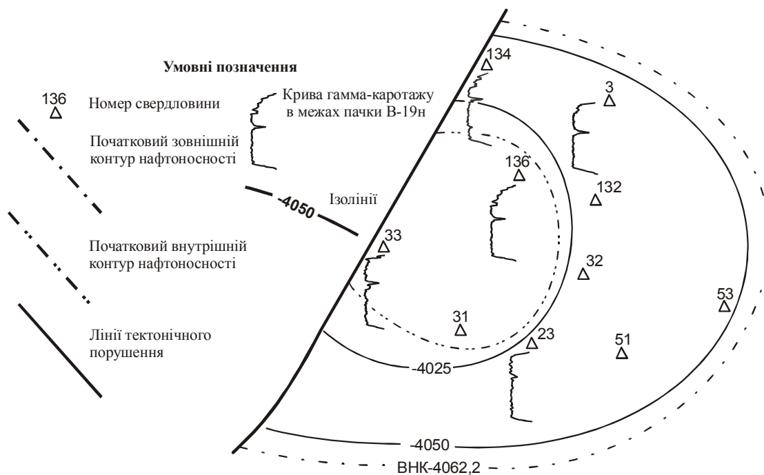
Рисунок 5 – Структурна карта покрівлі горизонту В-19н Коржівського нафтогазоконденсатного родовища на ділянці розташування свердловин №134, №3, №136, №33 і №23 (масштаб 1:10000) [15]
