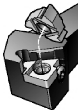
Рисунок 6 – Встановлення робочої різальної пластини на підкладну пластину
