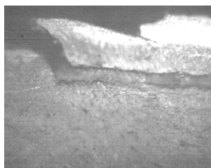
Рисунок 7 – Типове відшарування фрагментів цементованого шару (×500)
