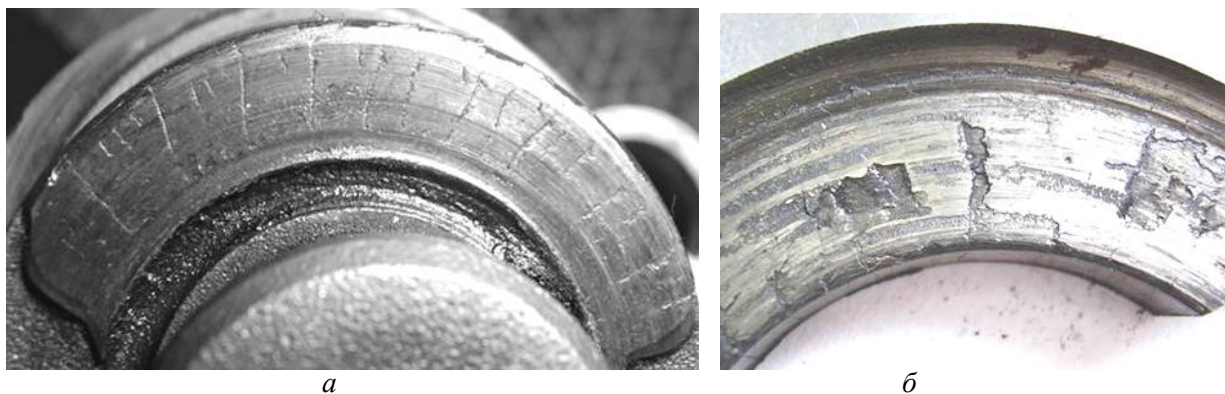
а – характер зносу напаяного упорного торця лапи (×2) б – зруйнована цементована поверхня торця шарошки (×4)
