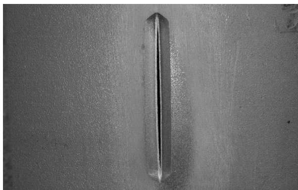
Рисунок 13 – Загальний вигляд розриву випробуваних у метані (а) та газоподібному водні (б) труб біля концентратора напружень – вигляд із зовнішньої сторони труби
