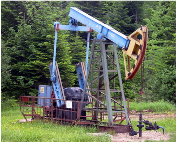
Рисунок 1 – Свердловина №246-Д НГВУ “Долинанaftогаз”, яка обладнана СШНУ з верстатом-гойдалкою UP-12Т (редуктор R-55) після 28 років експлуатації
