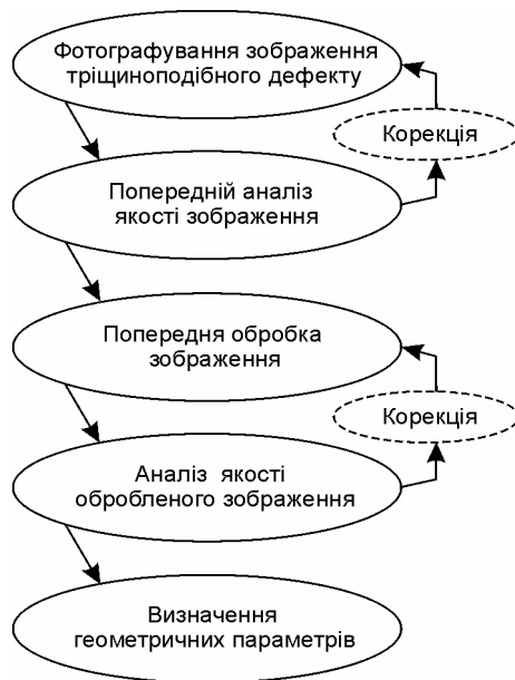
Рисунок 3 – Структурна схема процесу визначення геометричних параметрів тріщиноподібних дефектів
