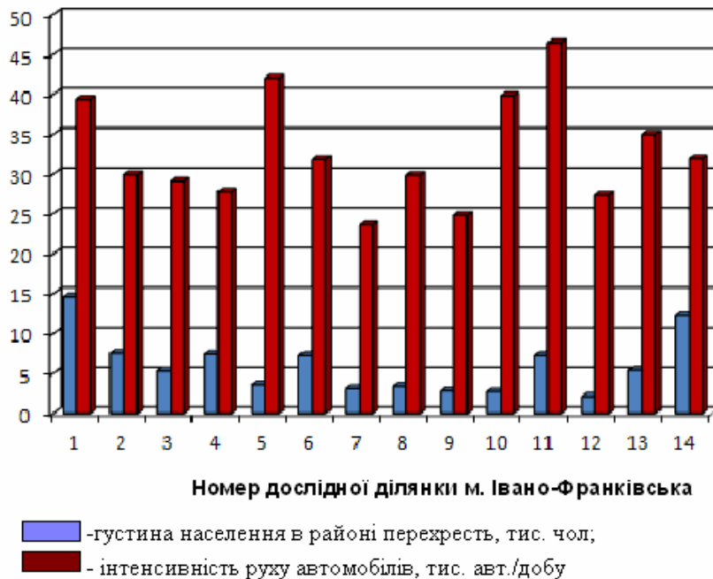
Рисунок 1 – Гістограма густини населення та інтенсивності руху автомобільного транспорту на дослідних ділянках м. Івано-Франківська у зимовий період
