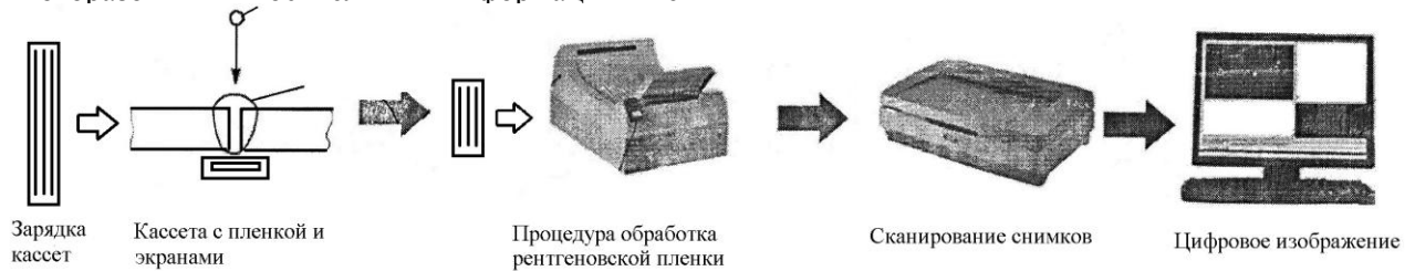
Рисунок 1 - Традиционная схема радиографического контроля с использованием пленки и оцифвки рентгенограмм
