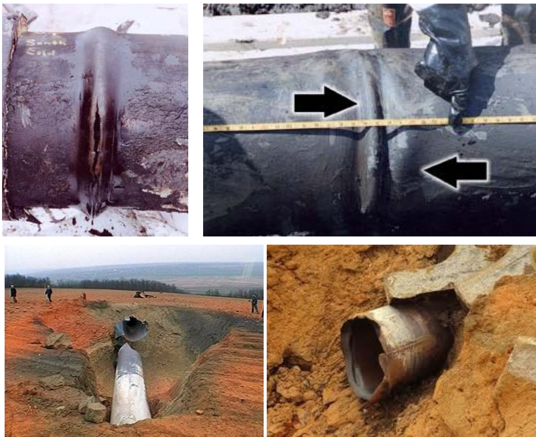
Рисунок 1 – Приклади руйнувань трубопроводів, пов'язані з впливом геодинамічного фактора
