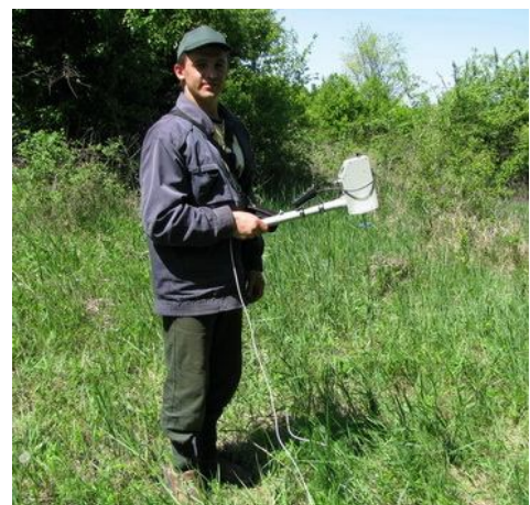
Рисунок 5 – Проведення вимірювання напруженості геоелектричного поля по профілях за допомогою розробленої мобільної системи моніторингу «Пошук-1» для геодинамічного картування в зоні пролягання контрольованого газопроводу
