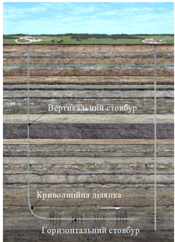
Рисунок 1 – Загальний вигляд профілю свердловини для видобування сланцевого газу
