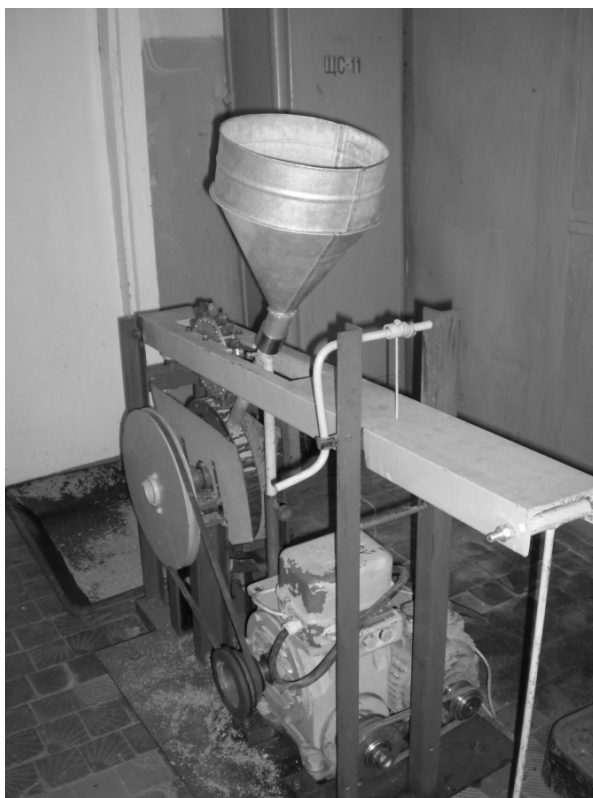
Рисунок 6 – Проведення досліджень на ударно-абразивне зношування елементів озброєння бурового інструменту
