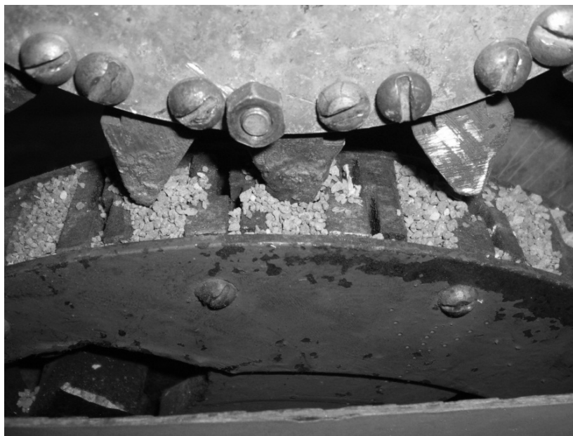
Рисунок 8 – Моделювання умов роботи елементів озброєння породоруйнівного інструменту
