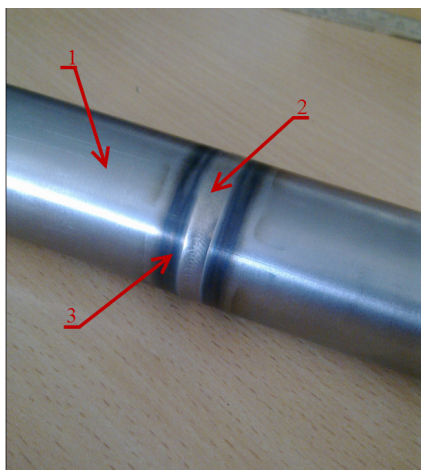
1 – основний метал; 2 – зварний шов; 3 – зона термічного впливу
