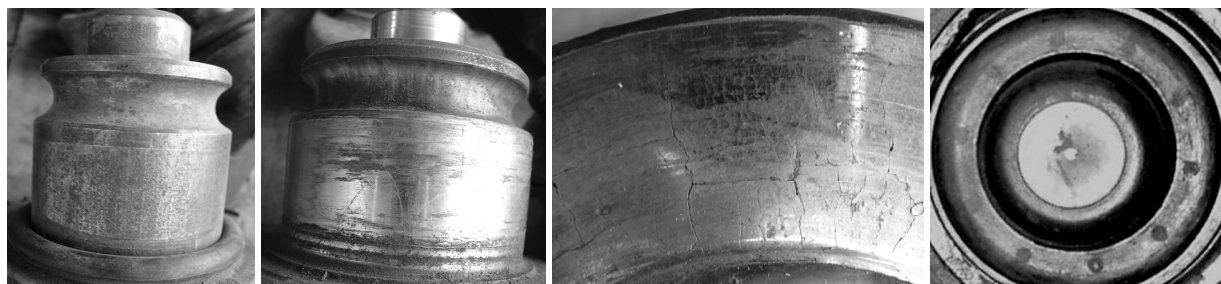
а – загальний знос опори і піттинги на біговій доріжці замкового кулькового підшипника кочення ; б – загальний знос опори та тріщини на наплавленій поверхні великого підшипника ковзання; в – тріщини і дрібне викришування наплавленого шару упорного торця лапи; г – утворення на упорному торці шарошки притертої канавки, що відповідає поверхні торця лапи
