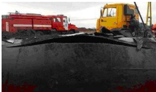
Рисунок 1 – Поздовжній розрив нафтопроводу "Дружба-1" діаметром 530 мм [5]
