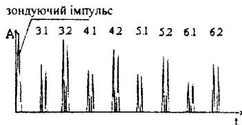
Рис. 3. Часова розгортка прийнятого сигналу, яка ілюструє повний цикл приходу імпульсів на перетворювач від чотирьох відбивачів
