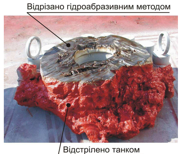
Рисунок 20 – Порівняння двох методів відрізання трубної головки 180×700-280×700 “CAMERON”
