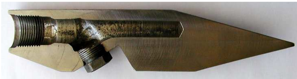
Рисунок 8 – Фактичне розмивання різачка з буферною камерою
