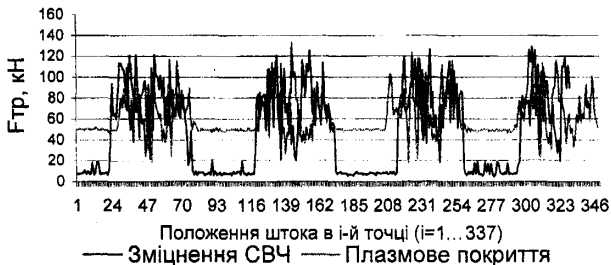
Рис. 3. Порівняльні діаграми зміни сил тертя при дослідженнях у буровому розчині в процесі випробувань (P=10 МПа) через 60 годин випробувань.
