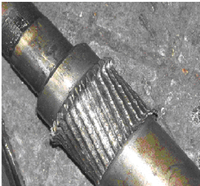
Рисунок 2 — Деформація зубів зубчатих валів
