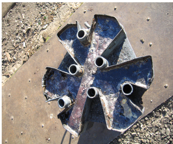
Рисунок 11 – Фрезер вибійний ФЗ-308 після операції пічного армування
