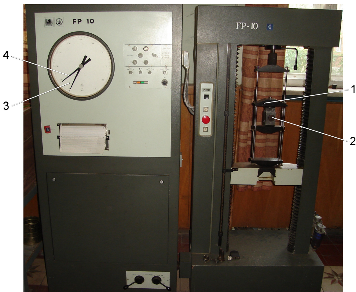
1 – динамометричний пристрій; 2 – пристосування для випробування на зріз; 3 – робоча стрілка; 4 – фіксуєча стрілка
