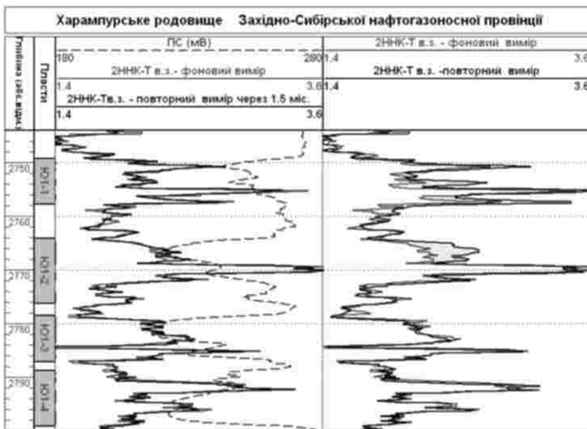
Рисунок 1 — Виділення газонасичених інтервалів за даними повторного нейтронного каротажу (ПНК) з різним часовим інтервалом дослідження
