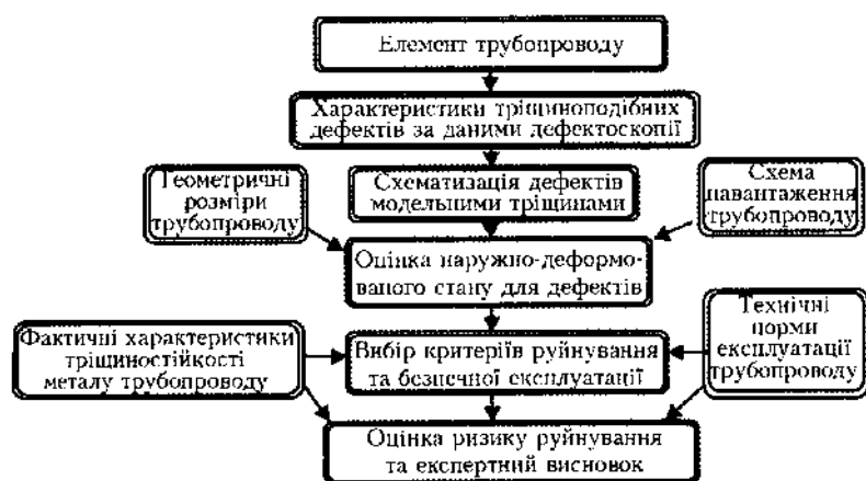
Рис. 1. Схема технічної діагностики та оцінки ризику руйнування елемента трубопроводу
