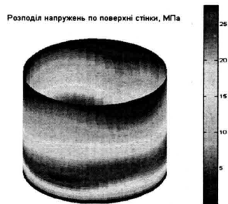
Рис. 5. Розподіл інтенсивності напружень в стінці резервуара, одержаних за допомогою розробленого програмного забезпечення
