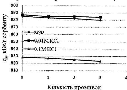
Рис. 17. Десорбція Cs-137 з відпрацьованого сорбційного матеріалу МКФ-ГМ:
