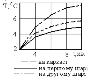
Рис. 4. Розподіл температур по шарах в шині 205/70R14 мод. ИД-220.
