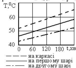
Рис. 1. Температура по шарах в шині 175/70R13 мод. EX-85.
