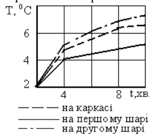
Рис. 3. Розподіл температур по шарах в шині 175/70R13 мод. EX-85.
