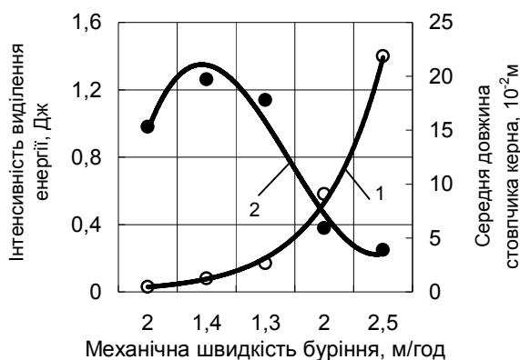
Рисунок 4 – Співвідношення між механічною швидкістю буріння та інтенсивністю виділення енергії зміни форми за одиницю часу ( t=1 с) (1), між механічною швидкістю буріння і середньою довжиною стовпчика керн (2)
