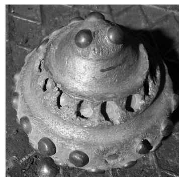
Рисунок 1 — Випадання твердосплавних зубків з тіла шарошок долота 269,9 ОК-ПВ-3
