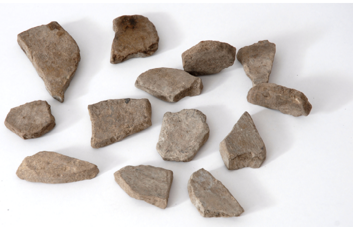
Рисунок 1 — Фотографія зразків цементного каменю зі свердловини 552 ГС Долина
